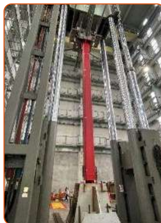
挫屈束制支撐試驗示意圖
