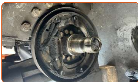
現況說明：#618 堆高機煞車異常， 煞車鼓異常磨耗
