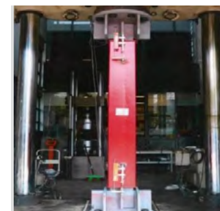
挫屈束制支撐試驗示意圖
